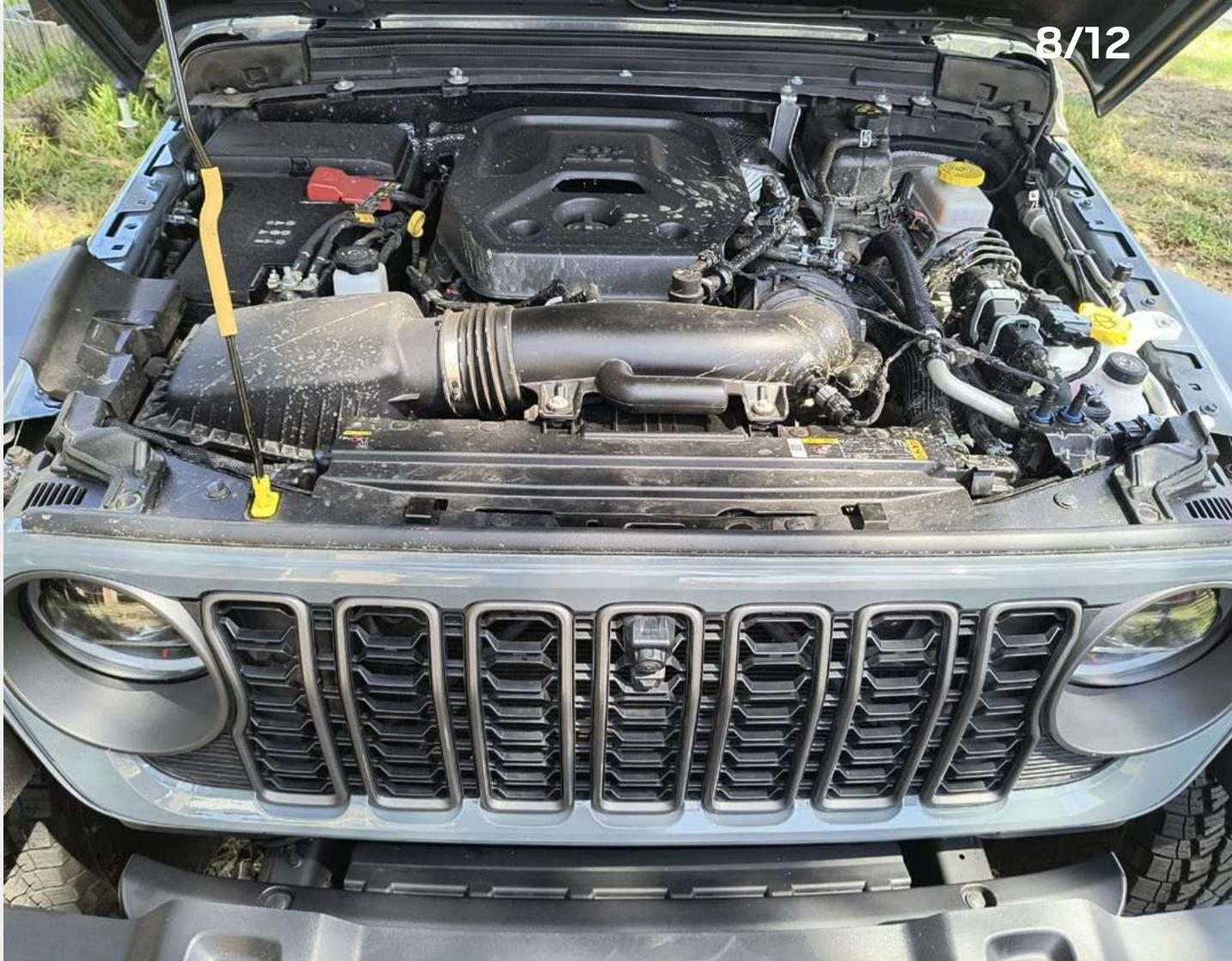
portentoso motor turbo 2.0 Hurricane de 272 cavalos de potência a 5.250 rotações por minuto e 40,8 kgfm de torque a 3 mil rpm, associado à transmissão automática de 8 marchas e ao mais deslumbrante e espetacular sistema de tração integral já desenvolvido pela Jeep para os terrenos mais difíceis. E vale repetir: “para os terrenos mais difíceis”. Se o Wrangler ficar preso em algum atoleiro, o problema não é o carro e sim o motorista, que certamente precisará fazer um curso de direção off-road.
