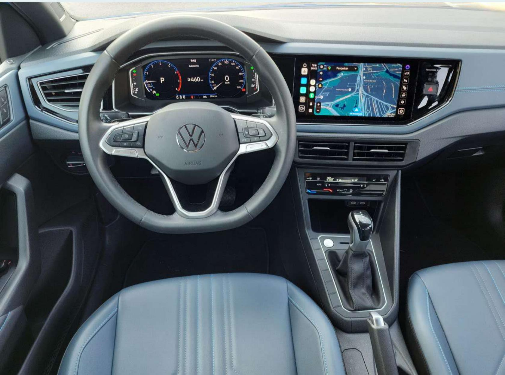
portas e apoia braço em destaque. Uma larga faixa em vinil azul atravessa todo o “tablier” e emoldura o painel de instrumentos e o multimídia. O acabamento repete o padrão do hatch Polo, com predomínio de plásticos duros, mas uma montagem precisa. Há regulagens
